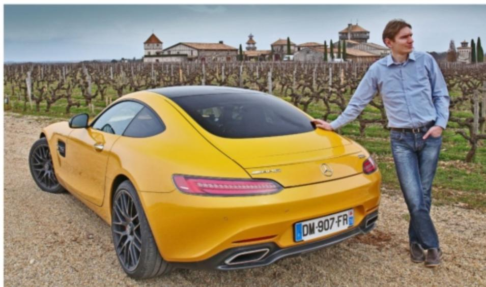
L'AMG GT reprend une version raccourcie de la plate-forme de sa devancière, la SLS AMG. La structure, entièrement réalisée en aluminium, ne pèse que 231 kg.
