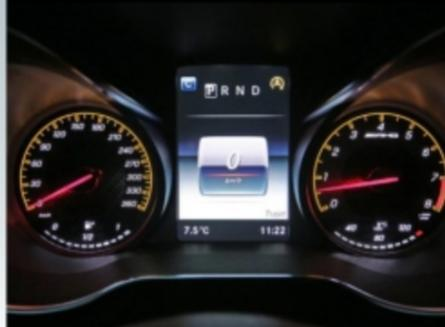
De jour comme de nuit, l'instrumentation est plutôt lisible... à l'exception du compteur, aux chiffres trop petits (et inutilement gradué jusqu'à... 360 km/h!). Heureusement, la vitesse peut être reprise dans l'afficheur central.
